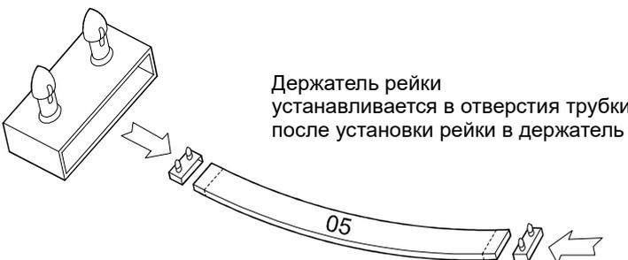
Держатель рейки устанавливается в отверстия трубки после установки рейки в держатель
