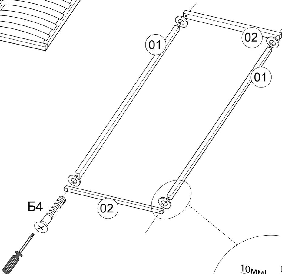
Отверстия под держатели реек в продольных трубках имеют смещение, при сборке отверстия должны быть сориентированы к внутреннему периметру рамки
